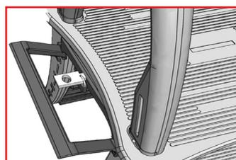
**Pour ouvrir l'échelle:** Ôter le cadenas et tirer la patte de blocage hors du pont. Remonter l'écran Rollguard® le faire coulisser jusqu'à l'autre côté par-dessus l'échelle intérieure. Enfoncer la patte de blocage et verrouiller avec le cadenas.
