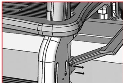
No 4: **ATTENTION!** Stabiliser l'échelle de la piscine en installant solidement les supports stabilisateurs. Les supports doivent être posés d'aplomb sur le rebord de la piscine et vissés en place.
