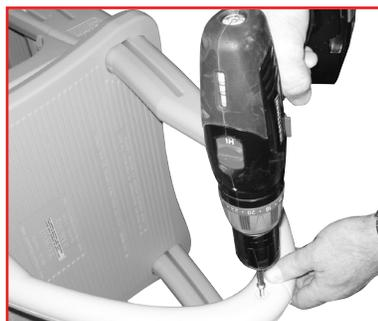
No 10 : Faire se chevaucher les bouts plats des moitiés de la première main courante et les fixer ensemble au moyen d'une vis auto-taraudeuse n° 10 de 1 ¼ po. Répéter sur l'autre main courante.
