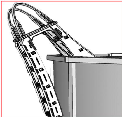
No 1: **ATTENTION!** L'échelle doit être placée sur une base solide et horizontale, à un endroit qui sera toujours bien à la vue d'un adulte apte à intervenir lorsqu'elle sera utilisée.
