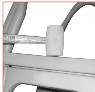
No 9 : Frapper doucement la plateforme pour bien l'enfoncer jusqu'aux ponts.
