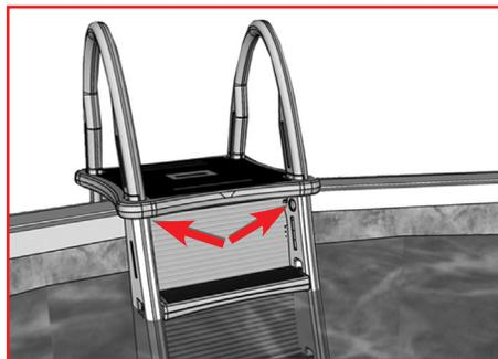
No 2: À l'aide du tuyau d'arrosage, remplir d'abord chacun des montants intérieurs par le trou de remplissage, puis poser les bouchons lorsqu'ils sont pleins. Plus les montants se rempliront, plus l'échelle s'enfoncera dans l'eau.
